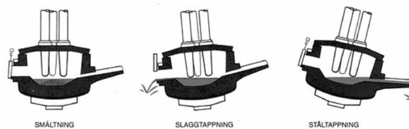
Nedsmältning av stålskrot i en elektrougn. Tappning av slagg och råslål
